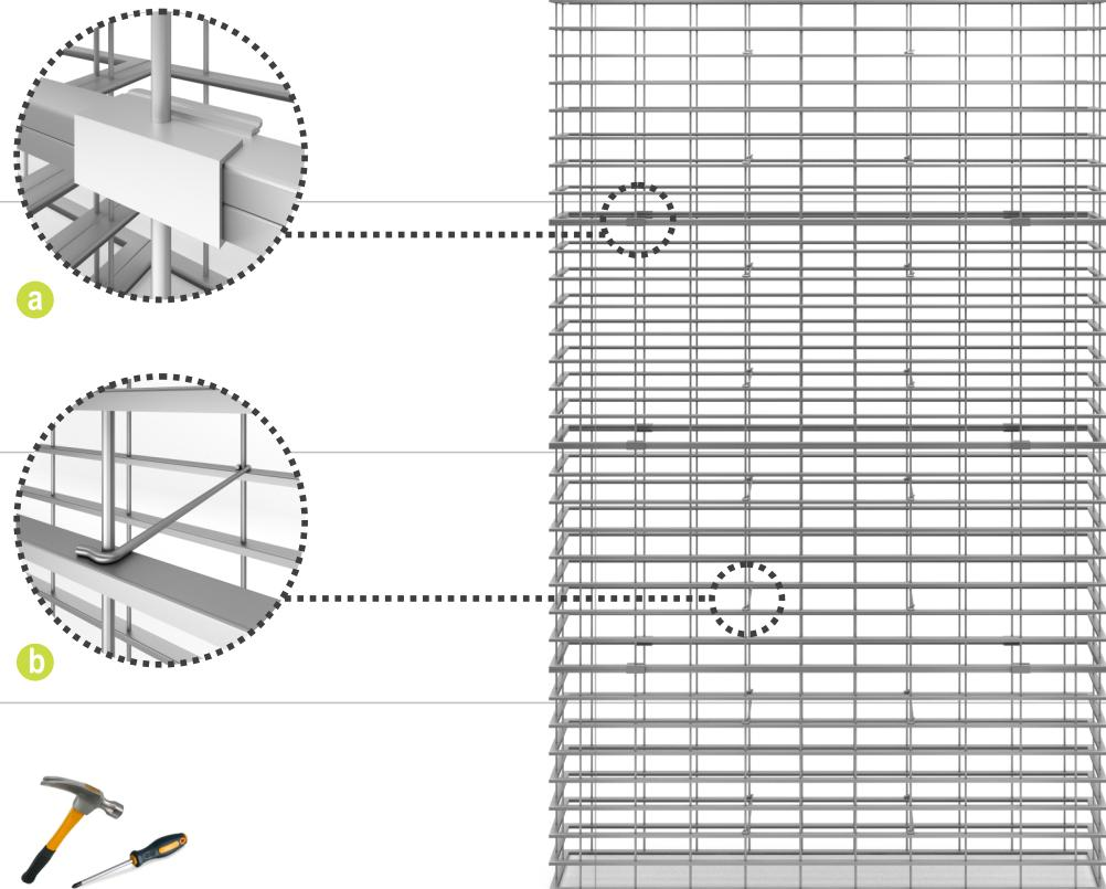
a) spinka montażowa „top” służąca do spiętrzania modułów
